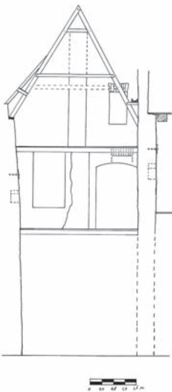
▲ Dwarsdoorsnede van Groenmarkt 33 gezien richting de achtergevel. Deze gevel is in de 14e eeuw gemetseld met centraal rookkanaal en enkele vensters. Op de begane grond is de gevel in de loop van de 20e eeuw gesloopt.
