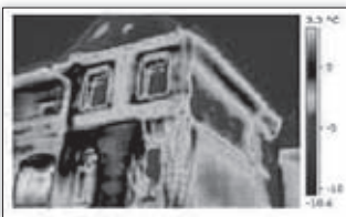
▲ Een infraroodscan van isolatielekken in een slecht geïsoleerde oude woning.
