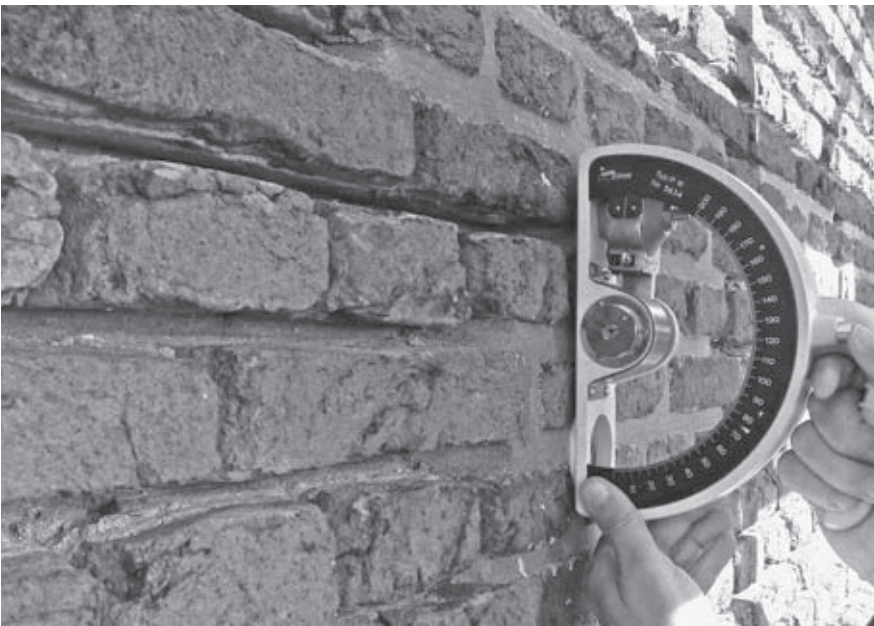
▲ Met een voeghardheidsmeter wordt de hardheid van de voegen gemeten. Foto Dirk Punt – gemeente Zutphen
