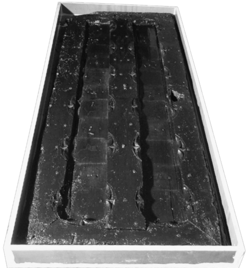
▲ De deur tijdens impregnatie in de speciaal vervaardigde impregnatiebak in de kelder van het restauratieatelier aan de Oude Wand.
